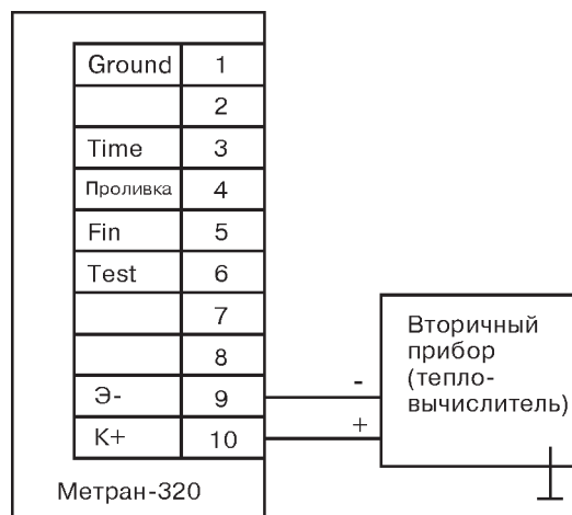
Рис. 1. Схема подключения расходомера Метран-320 к вторичному прибору.
