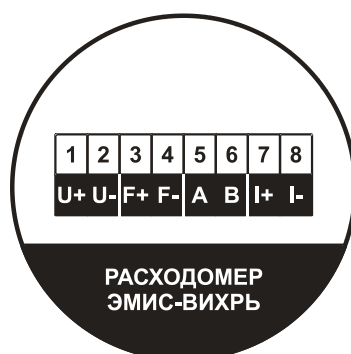
Рисунок Б.1 - Расположение зажимов клеммной колодки
