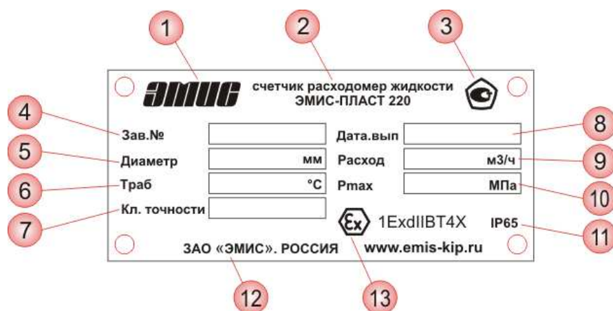
Рисунок 1.3 Основная табличка счетчика
