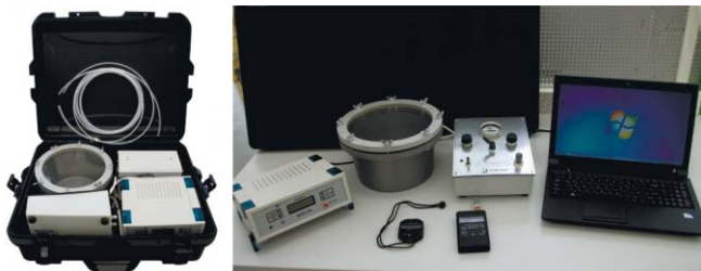
Рис. 6. Стенды для поверки и калибровки датчиков абсолютного давления
