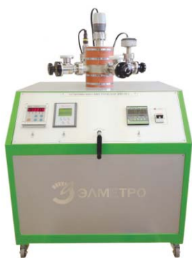
Рис. 9. Мобильная вакуумметрическая поверочная установка
