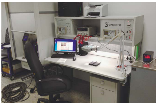
Рис. 12. Стенд поверки, калибровки и ремонта преобразователей температуры
