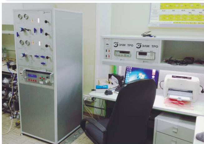
Рис. 13. Стенд поверки, калибровки и ремонта газоанализаторов в одном из ЦСМ
