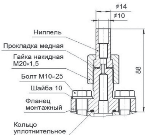
Рис. 1. Монтажный фланец (КМЧ M20) с наружной резьбой M20x1.5 и ниппелем с накладной гайкой M20x1.5 под приварку трубы 14x2 мм
