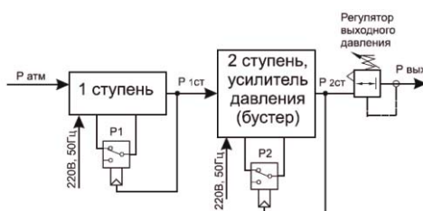
Построение двухступенчатых систем пневматического питания
