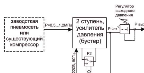
Расширение систем пневматического питания с помощью усилителя давления (бустера)
