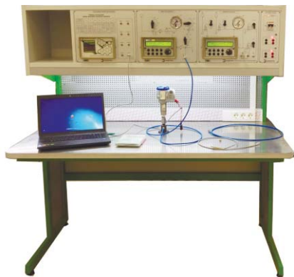
Рис. 1. Автоматизированный метрологический стенд поверки, калибровки и ремонта датчиков давления на базе калибраторов-контроллеров давления ЭЛМЕТРО-Паскаль и мультиметра ЭЛМЕТРО-Кельвин
