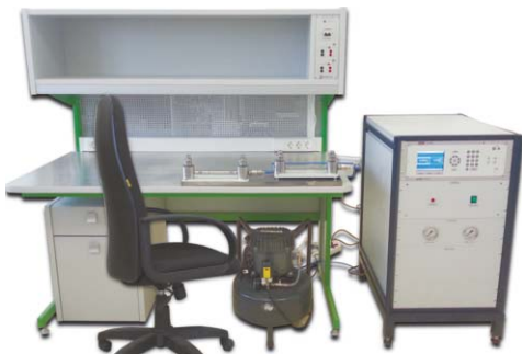
Рис. 5. Стенд поверки датчиков давления и манометров с коллектором и маломощным компрессором
