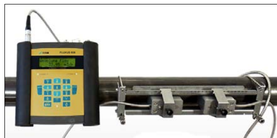
Измерение преобразователем расхода, установленным креплением QuickFix
