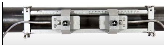
Измерение датчиками, смонтированными на портативном Variofix VP
