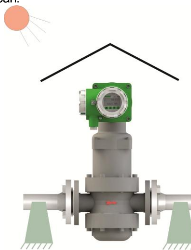
Рисунок. 2.5 - Общие требования к месту установки счетчика
