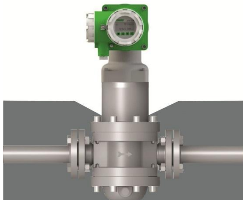
Рисунок 2.11 - Рекомендации по теплоизоляции счетчика
