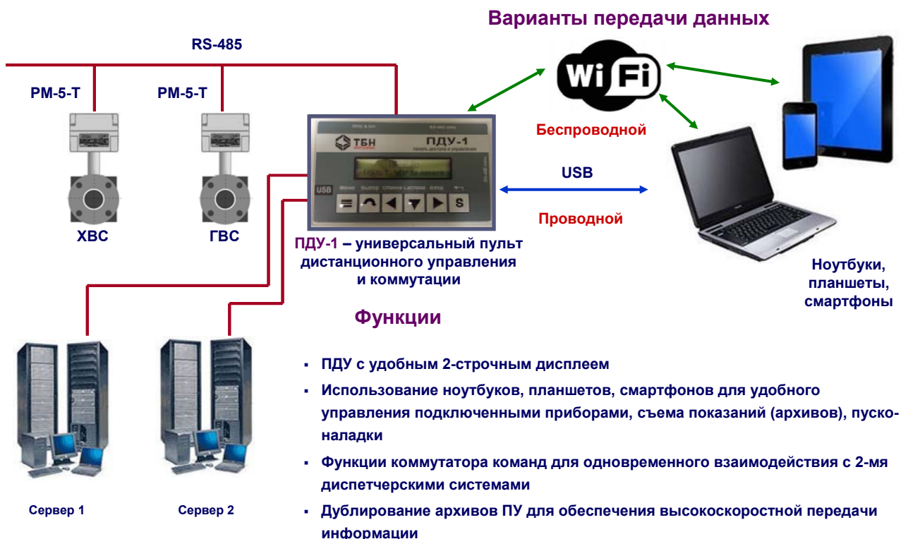
Рисунок 2 — Использование панели ПДУ-1 для управления РМ-5-Т
