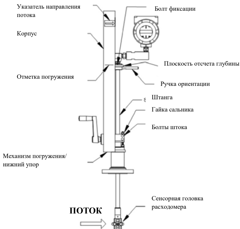
Рис. 11 Расходомер со стационарным механизмом погружения
