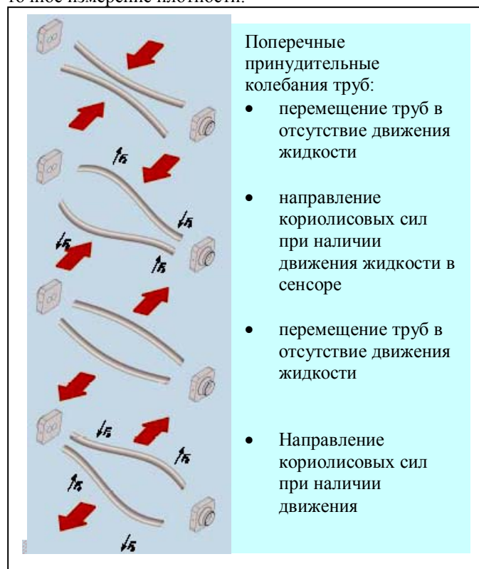
Рис. 1 Принцип работы 2-х трубной конструкции
