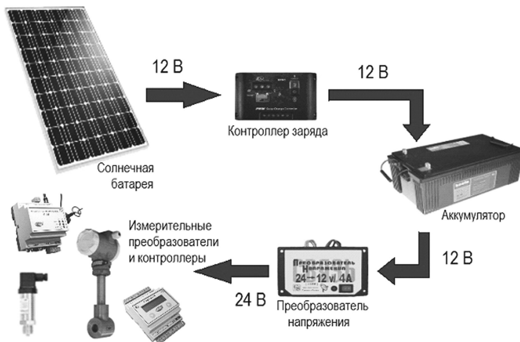
Рисунок 2. Принцип работы узла с солнечной панелью
