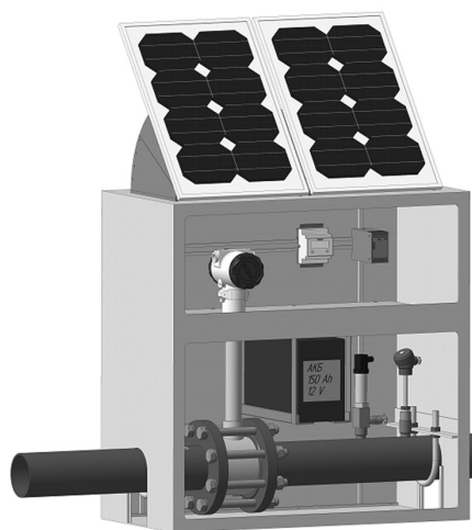
Рисунок 1. Конструкция узла ЭМИС-ЭСКО 2210-АИП с солнечной батареей
